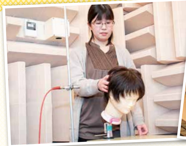
マネキンを使って髪を洗う際の音を測定しているところ
